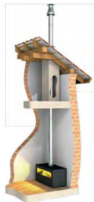
3 | Přímé napojení, ukončení vertikálním terminálem
