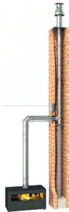
2 | Přechod koncentrického systému na nerezovou jednopláštovou pevnou vložku v původním komíně
