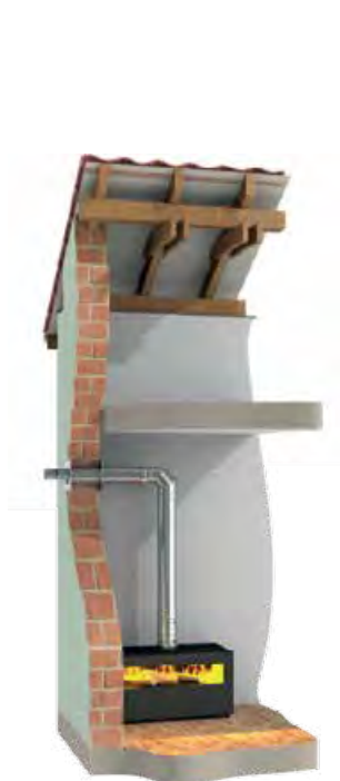
2 | Napojení přes stěnu pomocí horizontálního terminálu
