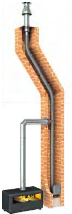
1 | Přechod koncentrického systému na nerezovou jednopláštovou flexi vložku v původním komíně
